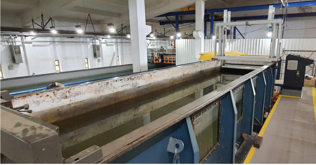
Şekil 3. Sirkülasyon kanalı ve GKT deney mekanizması
