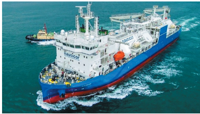
Şekil 12. Balastsız çalışan LNG bunker gemisi Kairos (The Maritime Executive 2019)
