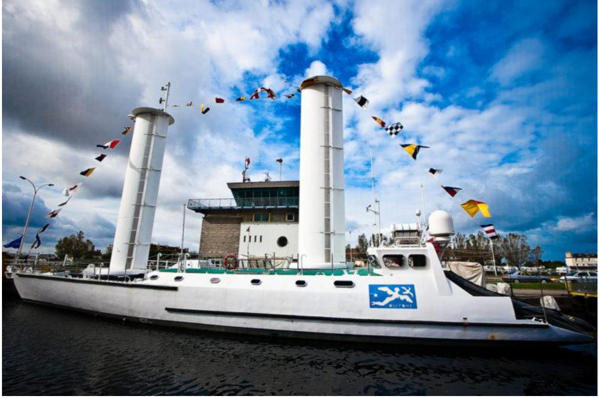
Şekil 1.2. Turbo-yelken entegre edilmiş The Alcyone teknesi (fr.cousteau.org)
