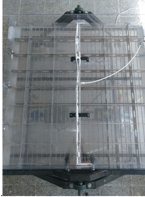
Şekil 3. Balast tankı modeli ve pnömatik hortum devresi (Bilgin Güney 2022)
