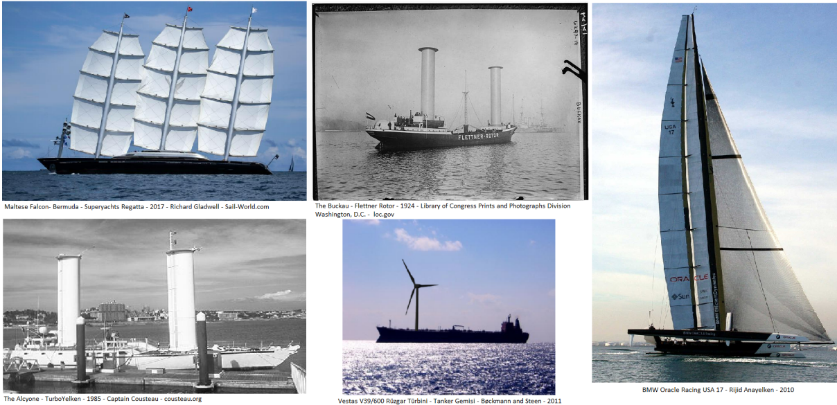
Şekil 1.1. Sağ üstten sola doğru rüzgâr sevk sistemleri: dynarig, flettner rotor, rijit yelken, turbo-yelken, dikey rüzgâr türbini (sail-world.com, loc.gov, wikipedia.org, cousteau.org, Bockmann & Steen).
