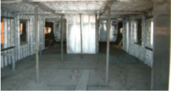
Şekil 10: Çelik ve alüminyum malzeme birlikte kullanılarak inşa edilen bir gemi [1].
