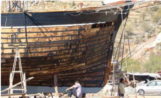
Şekil 20: Yığma (masif) olarak yapılmış bir gulet kalafatlanırken (Muğla-Fethiye, 2007) [1].
