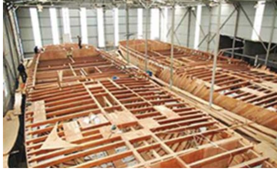
Şekil 2: İkiz ahşap gulet inşası (Muğla-Bodrum 2007) [1].
