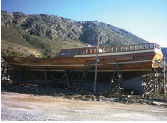
Şekil 8: Deniz kıyısından oldukça uzakta inşa edilen ahşap bir aynakıç (Muğla-Marmaris-Bozburun, 2007) [1].
