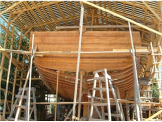
Şekil 18: Ayna kılı bir gulet inşa edilirken (Muğla-Marmaris-Bozburun, 2007) [1].
