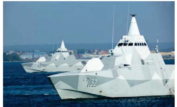
Şekil 10. 72 m uzunluğunda karbon fiber takviyeli sandviç kompozit malzemeden üretilmiş The Visby Class Stealth-Corvettes savaş gemisi [30].
