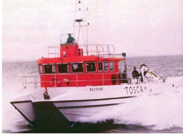
Şekil 16. Kevlar takviyeli kompozit malzemeden üretilmiş katamaran [32].
