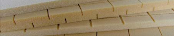
Şekil 6. Sandviç kompozit yapılar için kullanılan PVC köpük malzeme [26].
