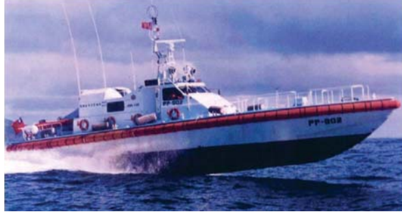
Şekil 14. Kevlar takviyeli kompozit malzemeden üretilmiş Tayvanlı devriye teknesi [32].
