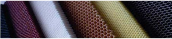
Şekil 7. Sandviç kompozit yapılar için kullanılan aramid balpeteği malzemeleri [27].
