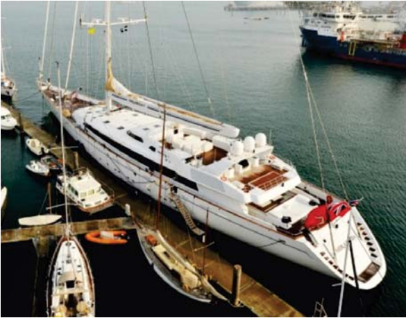
Şekil 13. 75.2 m uzunluğunda karbon elyaf takviyeli kompozit/cam elyaf takviyeli kompozit/polyolefin köpük sandviç kompozit malzemeden üretilmiş VT Mirabella V yelkenli yat [31].
