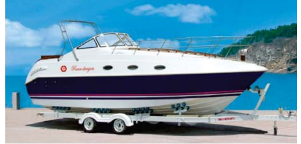
Şekil 9. 9.32 m uzunluğunda cam fiber takviyeli kompozit malzemeden üretilmiş lüks yat [29].
