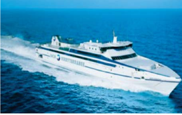
Şekil 11. 128 m uzunluğunda karbon fiber takviyeli sandviç kompozit malzemeden üretilmiş yüksek hızlı feribot [30].
