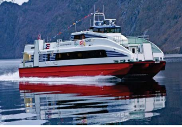
Şekil 12. 24.5 m uzunluğunda karbon fiber takviyeli sandviç kompozit malzemeden üretilmiş yüksek hızlı kataraman feribot [30].
