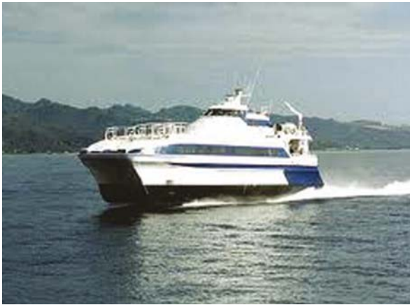
Şekil 5 Foil Cat 2900 hidrofoil sistemli katamaran
