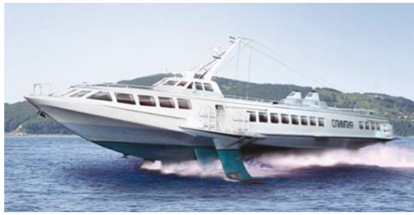
Şekil 2 Seyir halinde Olympia tipi hidrofoil teknesi
