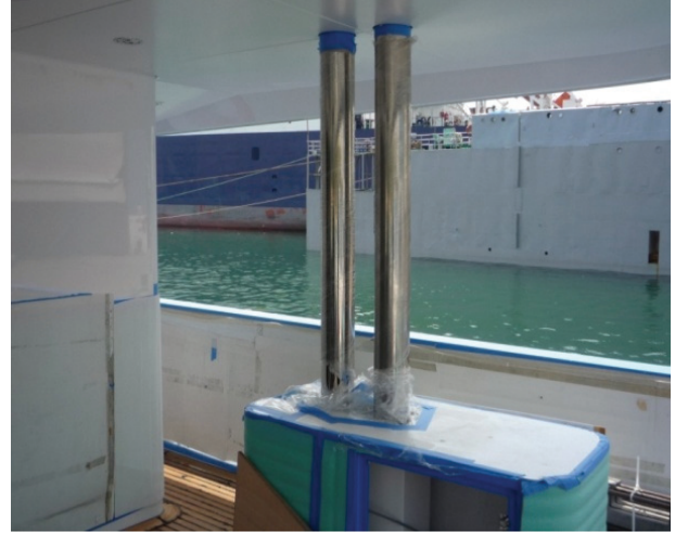
Şekil 3. Güverte vardavelaları ve dış ortam puntelleri.
