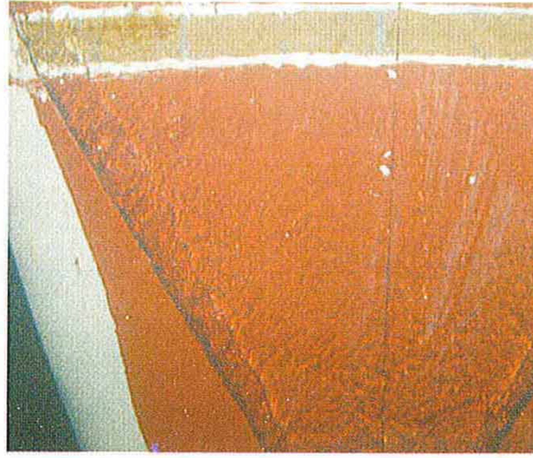
Şekil 3.6: Model üzerinde oluşan hava filmi
