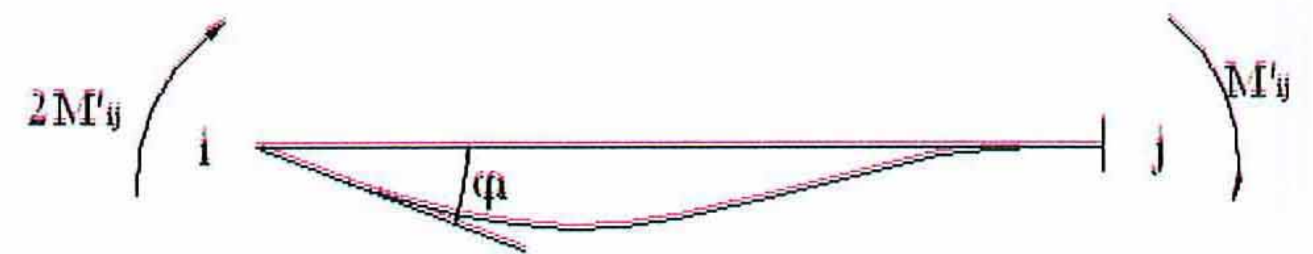
Şekil 2. j ucu sabit olan kiriş hali
