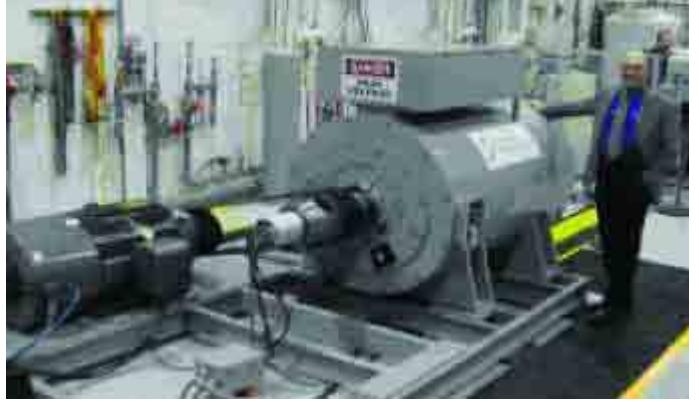
Şekil 9. 5 kW elektrik motoru test aşamasında
