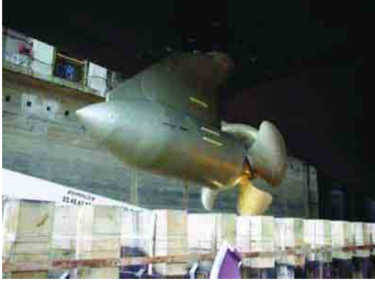
Şekil 2. Gemiye bağlanmış önden çekişli podlu pervane.
