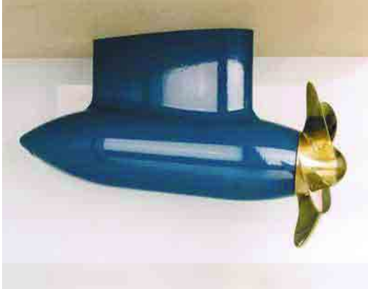
Şekil 1. Önden çekişli (Pull Type-Tractor Type) model podlu bir pervane.
