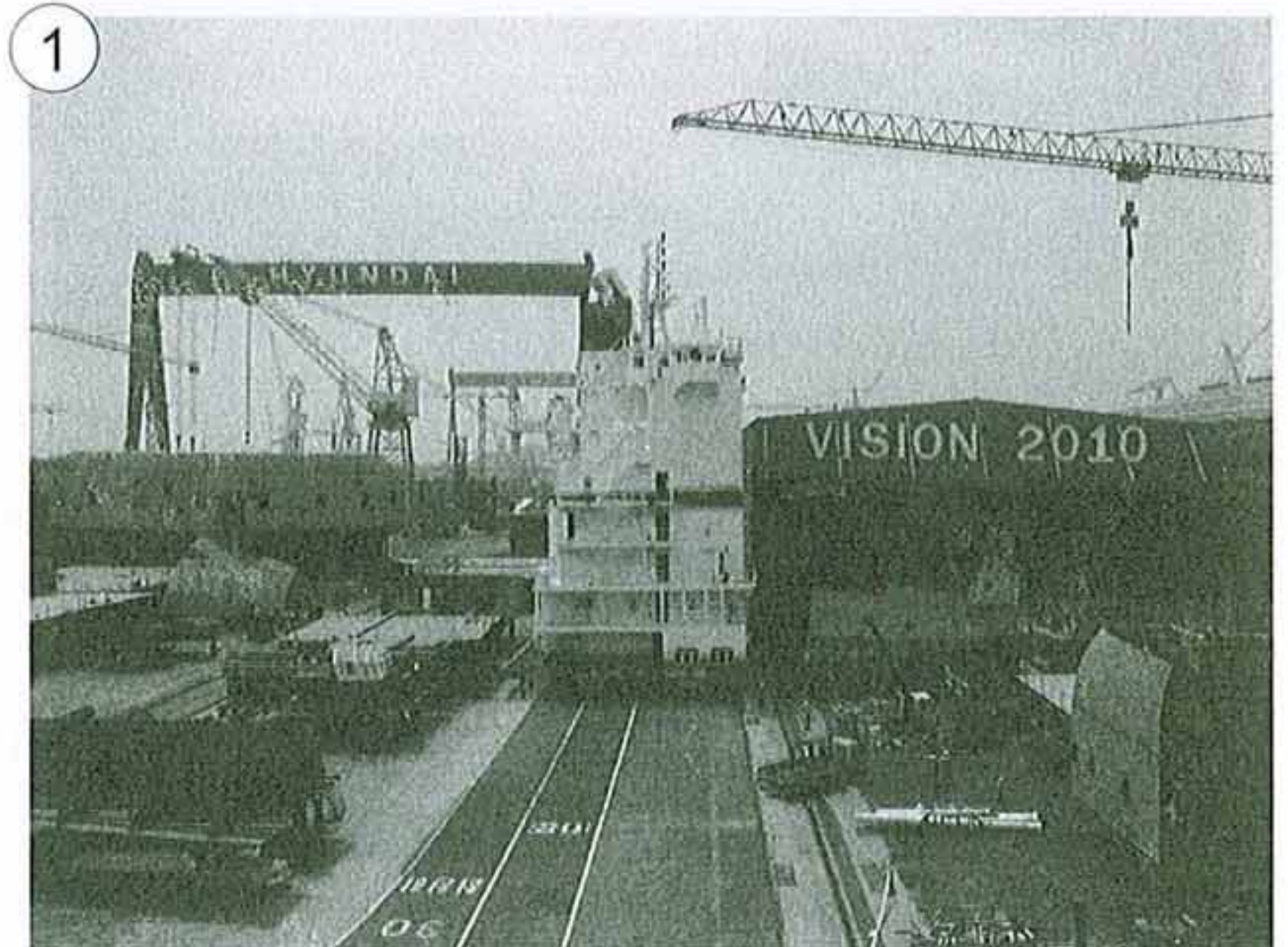
Bir konteyner gemisi üst binasının tersane içinde nakli. İçinde bir tek mobilyalar eksik.
