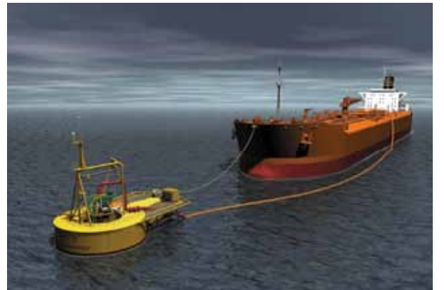
Şekil 1. Tek noktadan bağlı tanker-şamandıra bağlama sistemi
