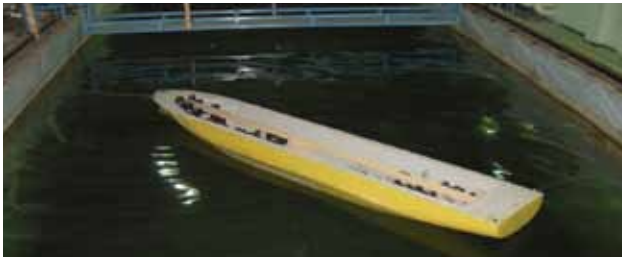
Şekil 8. 5 noktadan bağlı sistem (dalgalar 45° açıyla geliyor)
