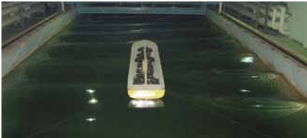
Şekil 7. 1 saniye periyotluk dalgada 4 noktadan bağlı sistem (model ölçeğinde)
