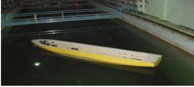
Şekil 5. 2 noktadan bağlı sistem (Model 45° açılı)
